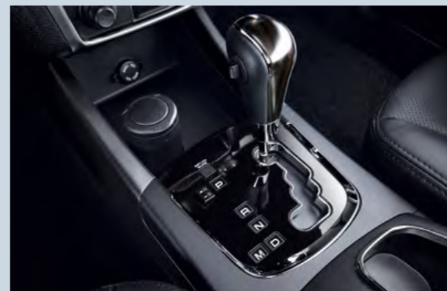
6-ти ступенчатая автоматическая коробка передач E-Tronic с возможностью ручного переключения отслеживает и подстраивается под привычный для водителя стиль езды, и определяет оптимальные моменты переключения для большей плавности движения, и экономичного расхода топлива.
